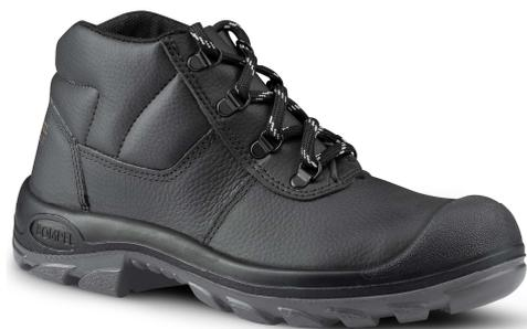
Botín de seguridad, en cuero flor hidrofugado, cierre en cordón, puntera acero sobrepuesta en PU, plantilla resistente a perforación en acero, lengüeta fuelle, collarín acolchado, ojales metálicos, suela en poliuretano (PU) doble densidad inyectado directamente a la capellada.
